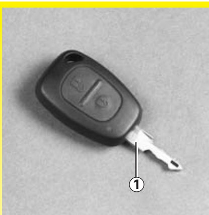
1 Radiofrekvenční dálkové ovládání, klíč ke spínací skříňce, dveřím a uzávěru palivové nádrže.
