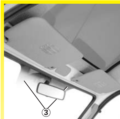
Přední sklo s reflexní vrstvou Tato úprava předního skla umožňuje omezit působení slunečního záření (především infračervených paprsků) jejich odrazem. Na skle jsou dvě oblasti 3 , na níž je možné umístit autorizační známky (např. dálniční nebo parkovací známky atd.).
