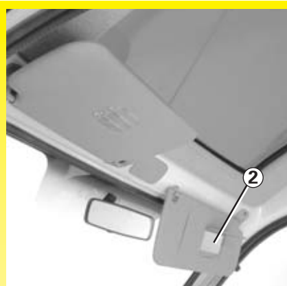
Kosmetická zrcátka 2 Zvláštnost na straně řidiče Pokud je sluneční clona vybavena kosmetickým zrcátkem, je zrcátko opatřeno krytem.
